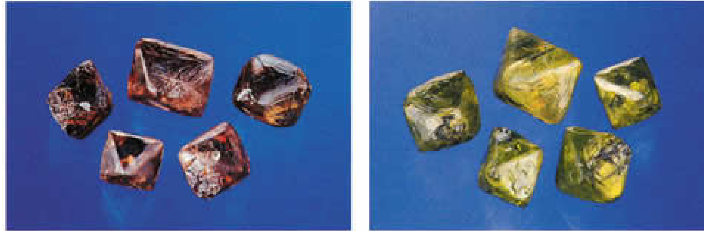
図4 5個のダイヤモンド結晶(1.90~4.45 ct)は、ナバテクによる高温高压処理後、ブラウンからグリーン・ニッシュイエローに変化した。写真はエリザベスシュレーダー撮影
