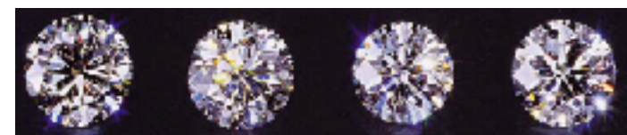
図 14 表 1に示されているように、左端のダイヤモンド(RD24)のテーブルサイズは大きく(66%)、他の3個(RD01, RD23, RD13)でははるかに小さかった(52~ 54%)が、DCLR値はいずれもほぼ同じであった。
