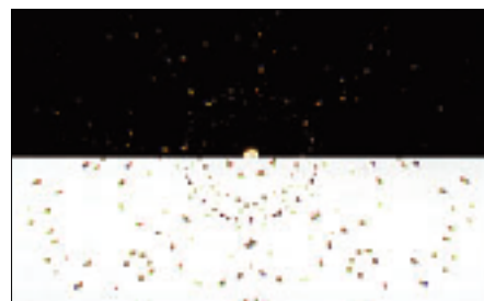
図5 シンメトリーが極めて良好な0.61ctのラウンドブリリアントから出たクロマティックフレアのパターン(上)と、この実物のダイヤモンドの平均プロポーションを備えた仮想ダイヤモンドのVF図(下)を比較した結果、計算によって作成した図におけるクロマティックフレアの位置が実際に光が出た位置とほぼ一致していることが明らかになった。写真はアル・ギルバートソン攝
