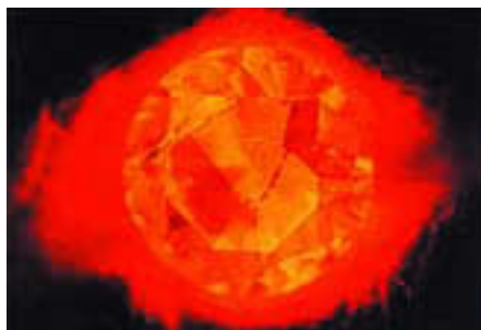
合成ピンク ダイヤモンドのカソード ルミネッセンス写真である。テーブルを通して合成石特有の成長構造の一部が確認できる。
